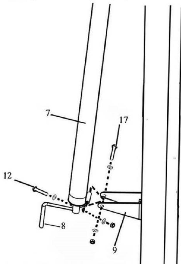
ШАГ 7. Прикрепите винтовой домкрат (7) к нижней опорной трубке (5) с помощью болта М12х220 мм (15).
