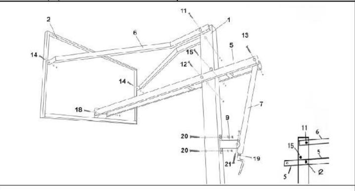
ШАГ 5. Закрепите кронштейн (9) по центру опорной стойки (1), используя болты М12х180 мм (20).
