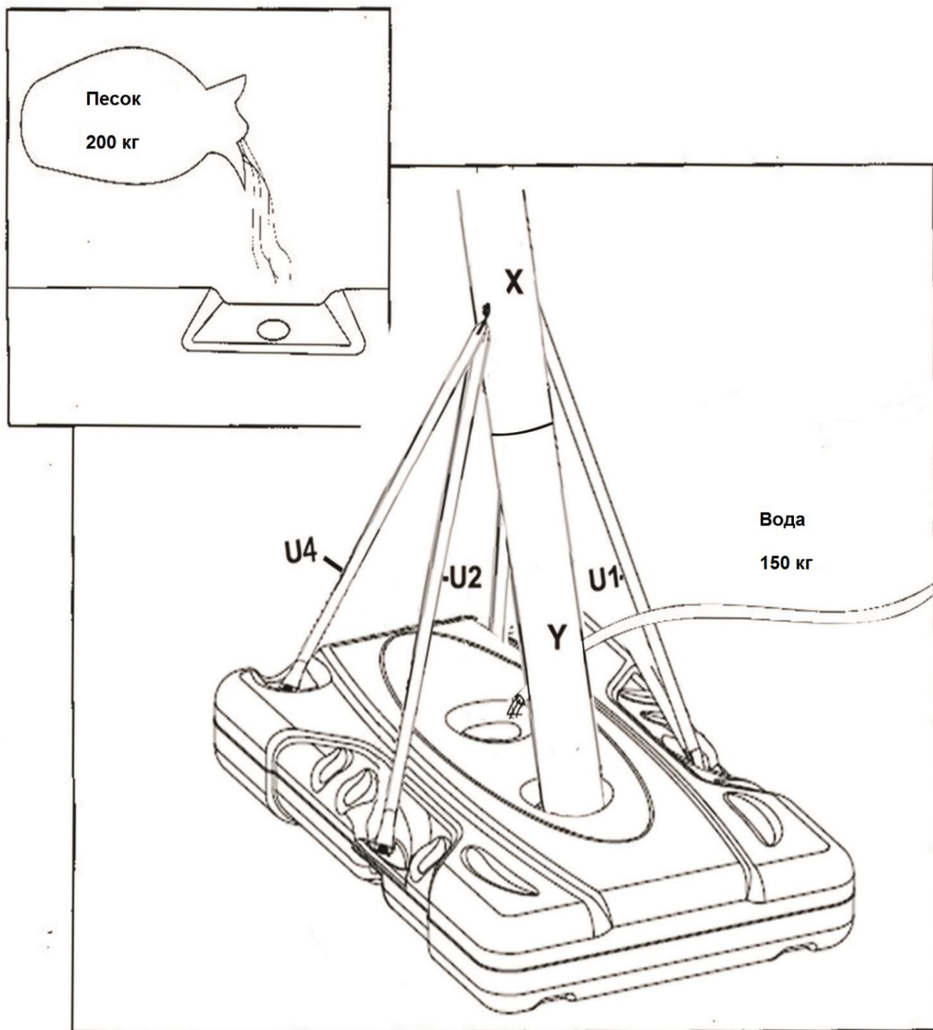
По соображениям безопасности рекомендуем использовать песок вместо воды для заполнения емкости утяжелителя. Если образуется небольшая течь, вода сможет вытекать из резервуара и система может опрокинуться, что станет причиной травмы или смерти или повлечет за собой материальный ущерб. Располагайте основание только на гладкой поверхности, вдали от посторонних предметов, которые могут повредить основание.
