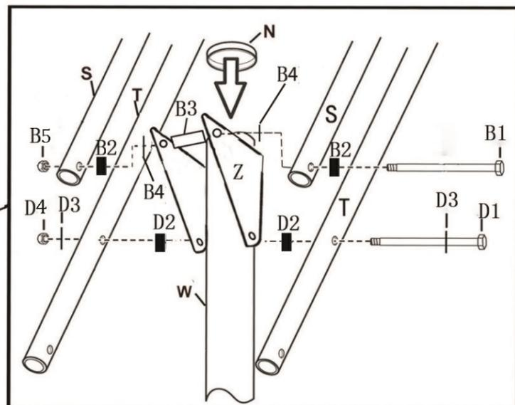
Как показано на рисунке снизу, соедините опоры щита (S,T) на блоке верхней стойки (Z) с помощью болтов (B1,B2,B3,B4,B5) (D1,D2,D3,D4). Вкладыш (B2) должен вставляться сбоку блока (Z) с болтом (B1), чтобы предотвратить потерю формы блока (Z). Наконец, вставьте заглушку в верхнюю стойку (W).
