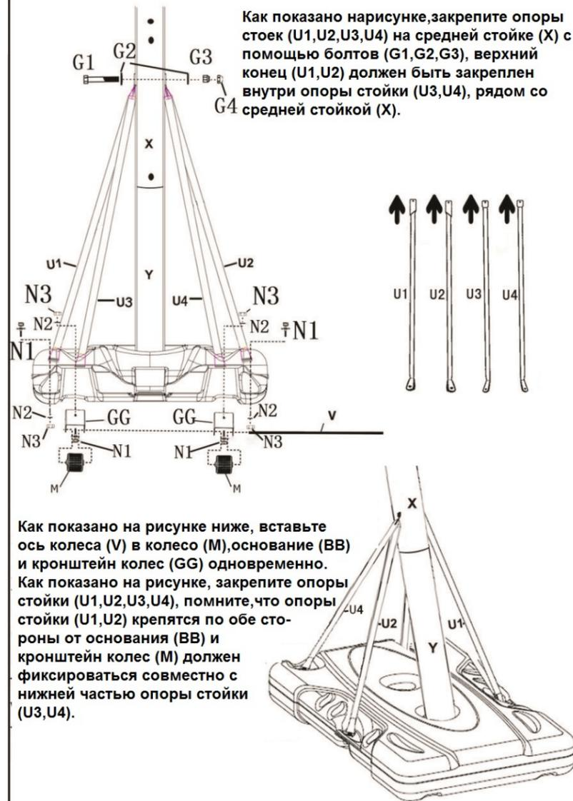
Как показано на рисунке ниже, вставьте ось колеса (V) в колесо (M), основание (BB) и кронштейн колес (GG) одновременно.
