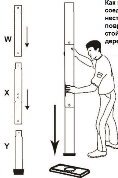
Как показано на рисунке, когда соединения стойки имеют нестыковки или наконечник поврежден, ударьте по нижней стойке 3-4 раза по бруску дерева или плотному картону.
