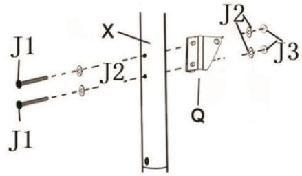
Установите треугольный блок (Q) на средней стойке (X) с помощью болта (J1),(J2),(J3).
